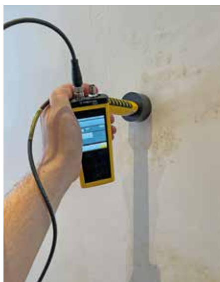
Bild links: Wärmebildaufnahme eines Wasserschadens im Bereich der Kniestockwand. Bild rechts: Feuchtemessung im Mikrowellenverfahren mit Messtiefen von 20-30 cm.
