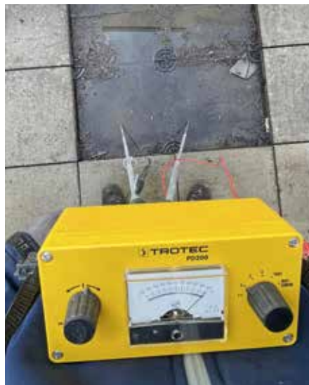
Bild links: Mit der Impulsstrommessung aufgefundene Leckage unter dem Terrassenbelag.
