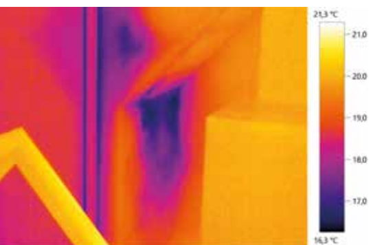
Bild links: Wärmebildaufnahme eines Wasserschadens im Bereich der Kniestockwand. Bild rechts: Feuchtemessung im Mikrowellenverfahren mit Messtiefen von 20-30 cm.
