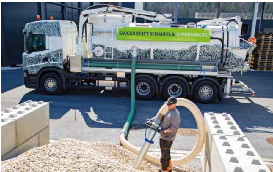
Mit den am Fahrzeug angebrachten Spezialaufbauten können sowohl flüssige als auch trockene Materialien eingesaugt und auch verblasen werden.
