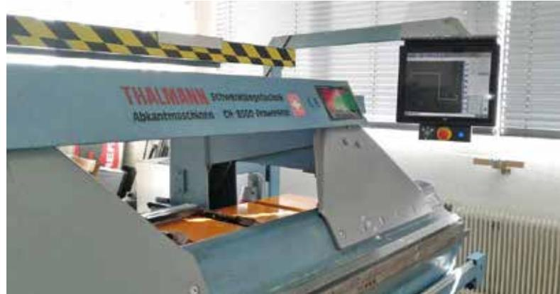
Mit AMS Controls Steuerungen werden alte Blechbearbeitungsmaschinen wieder funktionstüchtig gemacht.
