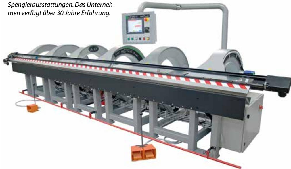
automatische Tiefenanschlag hat einen Vorschub von 25 mm bis 1.150 mm. Bei allen Maschinen werden die hydraulischen Pumpen mit Hilfe eines Elektromotors angetrieben, die für eine bessere Dynamik des Biegevorgangs frequenzreguliert sind.
