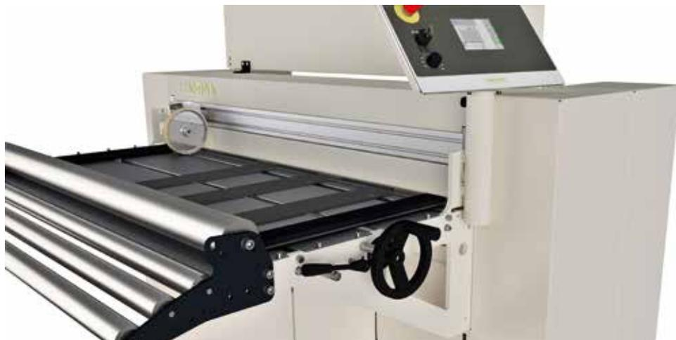
Ein Highlight der neuen SLIT-CUT ist die schnellere Spindel, mit der die Blechführung noch zügiger eingestellt und somit auch ein Blechwechsel effizienter durchgeführt werden kann.
