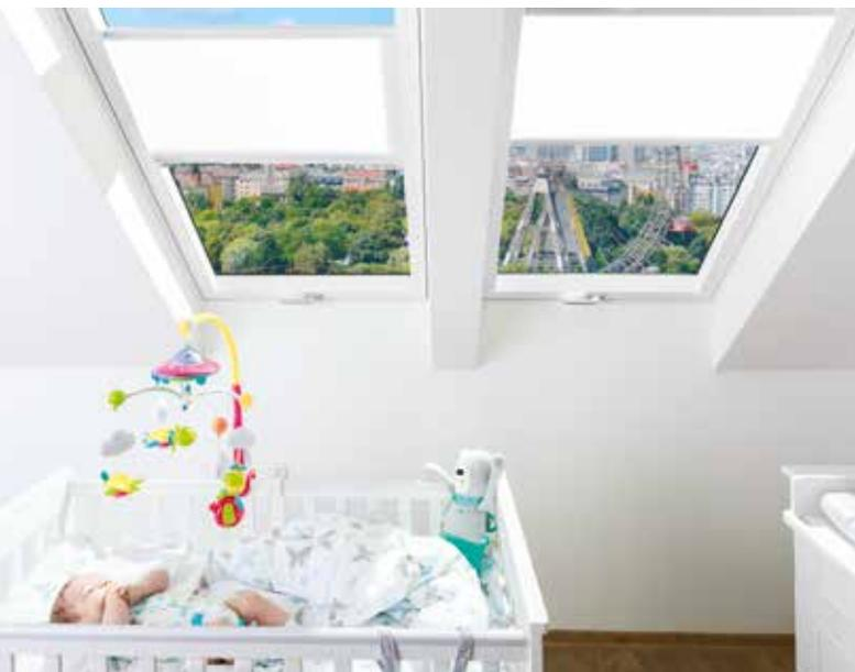
*Das dreifachverglaste Schallschutzfenster FPT MAX R3 mit einem Wert von 42dB verfügt über spezielle Dichtungen und kann aufgrund des hervorragenden Uw-Werts von 0,82 W/m<sup>2</sup>K auch für Passivhäuser eingesetzt werden.*
