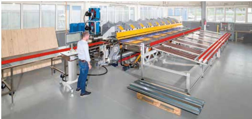
Hocheffiziente Profilherstellung: Die komplette Anlage kann von einem einzigen Mitarbeiter bedient werden. Die sich dadurch ergebenden Vorteile liegen auf der Hand.
