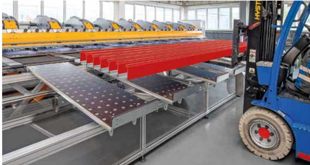
Praktische Entnahme: Lange und unhandliche Blechprofile können auch problemlos bspw. mit einem Stapler dem Kanteile-Puffer entnommen werden.
