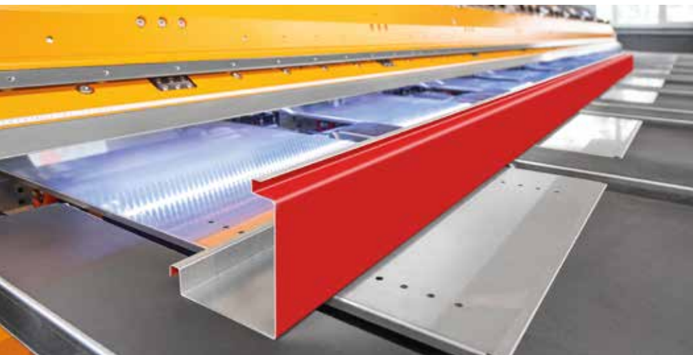
Die fertigen Blechprofile werden automatisch von den Förderbändern der automatischen Blechentnahme-Einheit übernommen und zum Kantteile-Puffer zur Entnahme befördert.
