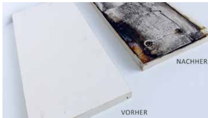
Die SF-Vakuumelemente Typ Firetherm wurden im Mai 2020 nach dem europäischen Brandverhalten EN 13501-1:2018 klassifiziert.
