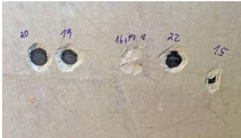
Noch beeindruckender ist dieses Ergebnis: Die Rückseite der Faserzementplatte wird abgeschlagen – die funktionssichere Enkopur-Abdichtung an der Vorderseite, bestehend aus Flüssigkunststoff und Enke-Polyflexvlies, wurde nicht beeinträchtigt.
